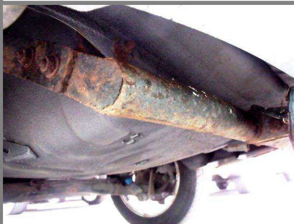
Obr. D11 – koroze rámu tažného zařízení
