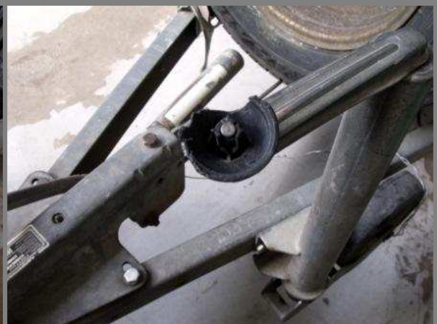
Obr. C15 – Poškozená rukojeť man. kolečka
