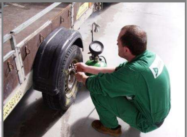
Obr. C36 – Kontrola předepsaného tlaku
