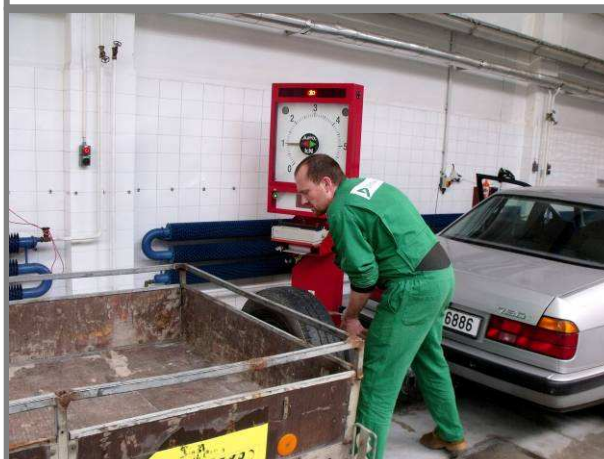
Obr. C46 – Zkouška zajišťovací brzdy
