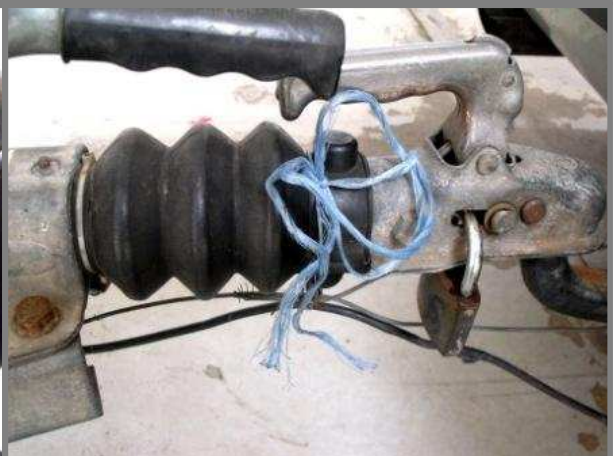
Obr. C42 – Zajištění prachovky a lana
