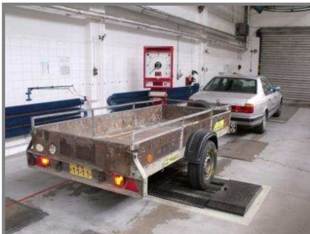
Obr. C44 – Souprava na válcové zkušebně
