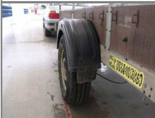
Obr. 29 – Nedostatečná velikost zástěrky
