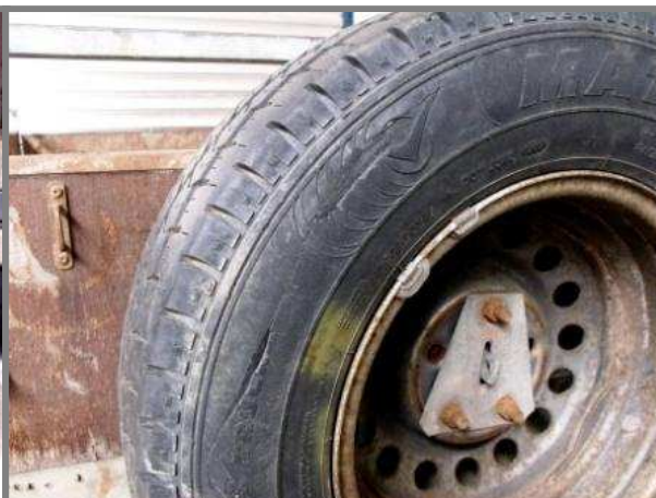
Obr. 28 – Poškozený plášť rezervního kola
