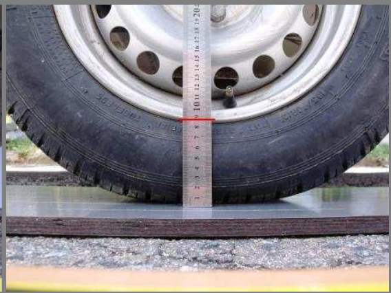
Obr. B27 – 130 kPa 250 kg
