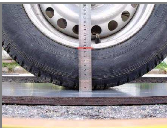
Obr. B17 – 230 kPa 0 kg
