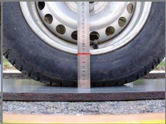
Obr. B29 – 130 kPa 500 kg
