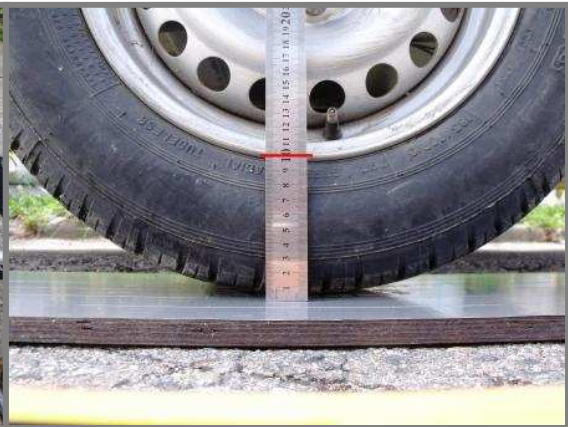
Obr. B9 – 330 kPa 0 kg
