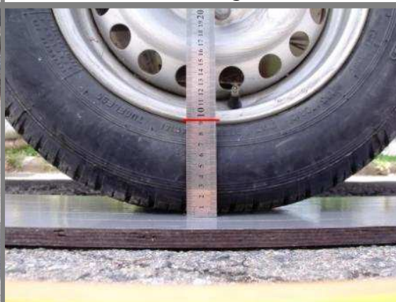
Obr. B19 – 230 kPa 250 kg
