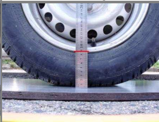
Obr. B21 – 230 kPa 500 kg
