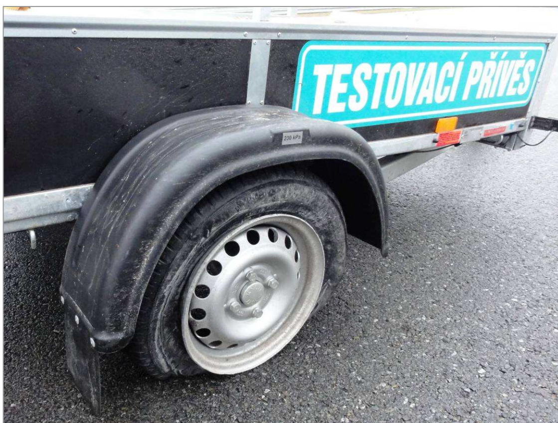
Obr. B4 – Znehodnocený disk a plášť po defektu
