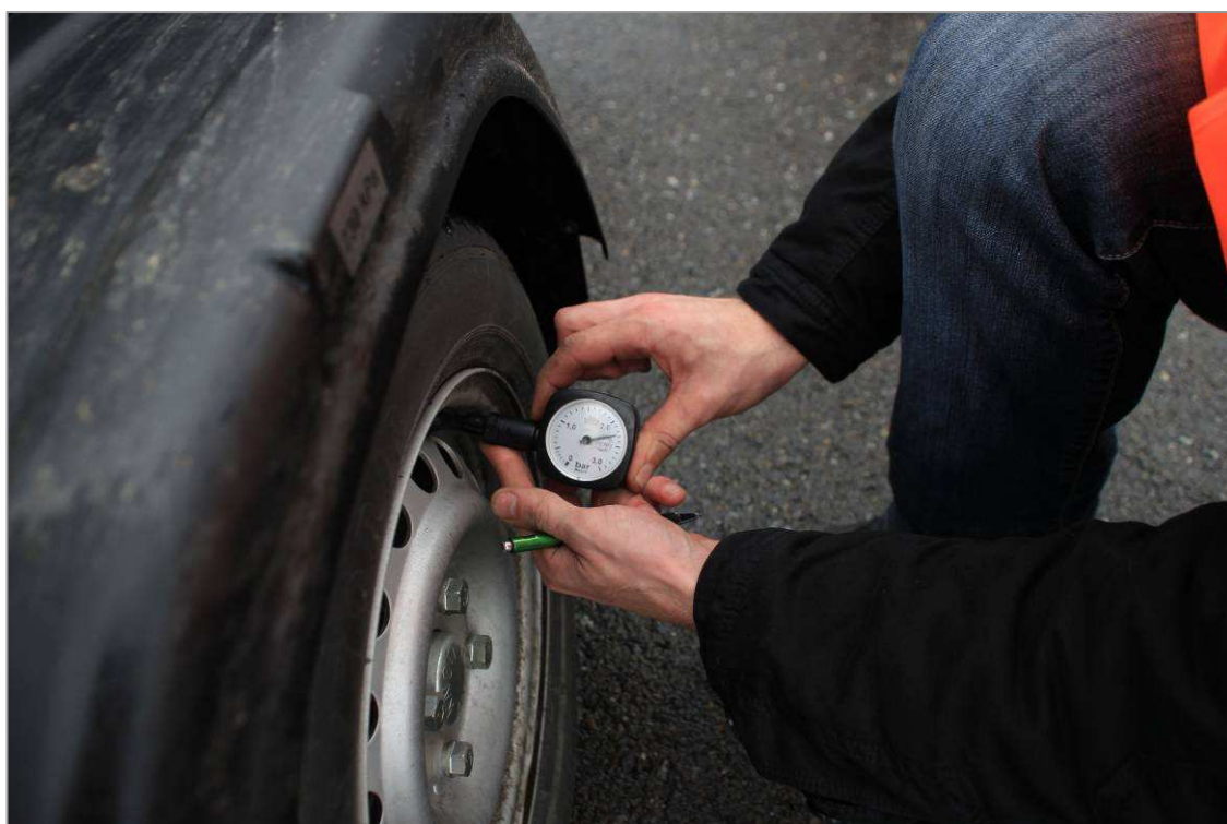
Obr. B2 – Měření tlaku před defektem – tlak 225 kPa
