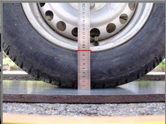
Obr. B13 – 330 kPa 500 kg
