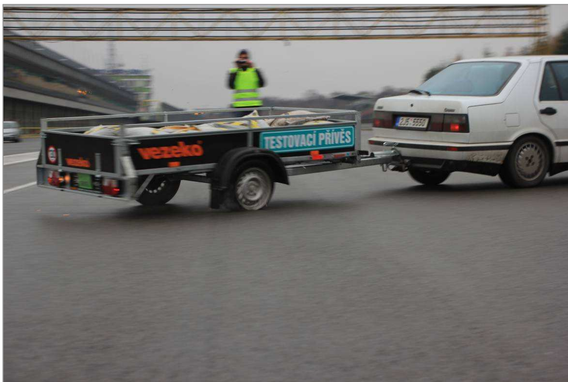
Obr. B1 – Defekt kola přívěsu při otáčení
