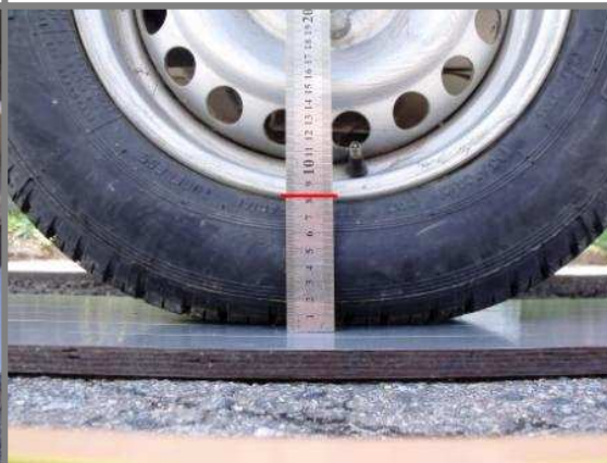
Obr. B23 – 230 kPa 750 kg
