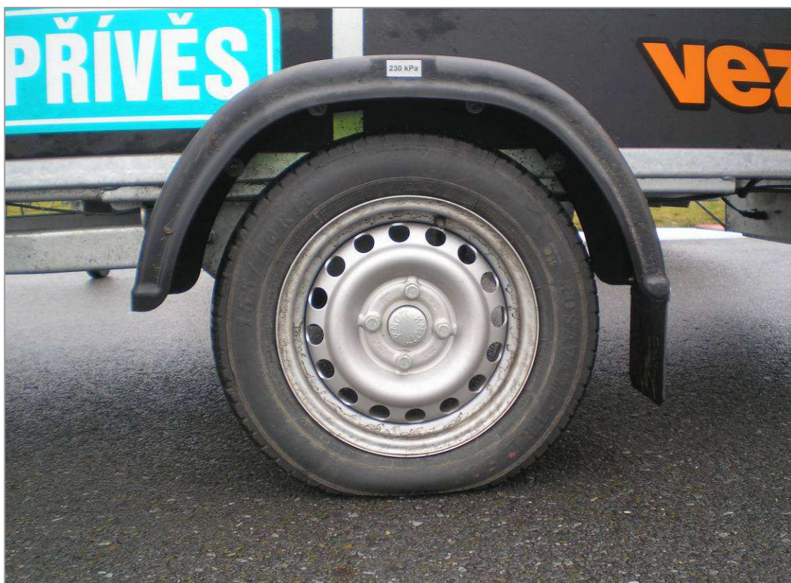
Obr. B3 – Deformace pneumatiky zatížením
