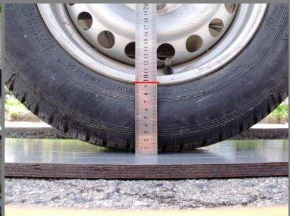
Obr. B11 – 330 kPa 250 kg
