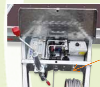
24. Hydraulický elektro-agregát s baterií a nouzovou ruční pumpou
