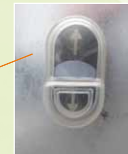
25. Vodotěsný spínač ovládání elektro-čerpadla na vnější straně schránky
