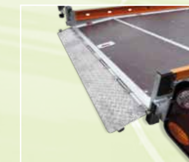
22. Nízká najížděcí rampa
